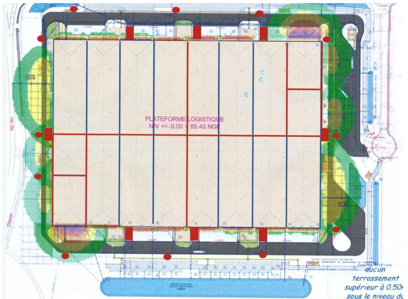
**Les résultats des simulations effectuées afin d'évaluer la toxicité aigüe des fumées produites en cas d'incendie montrent qu'aucune cible n'est susceptible d'être atteinte par les effets toxiques des fumées** en tenant compte des différences de dénivelé et des hauteurs maximales de construction
